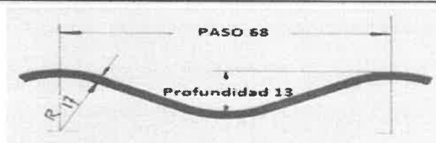
Figura 1. Dimensiones de la corruga 68.00 x 13.00
